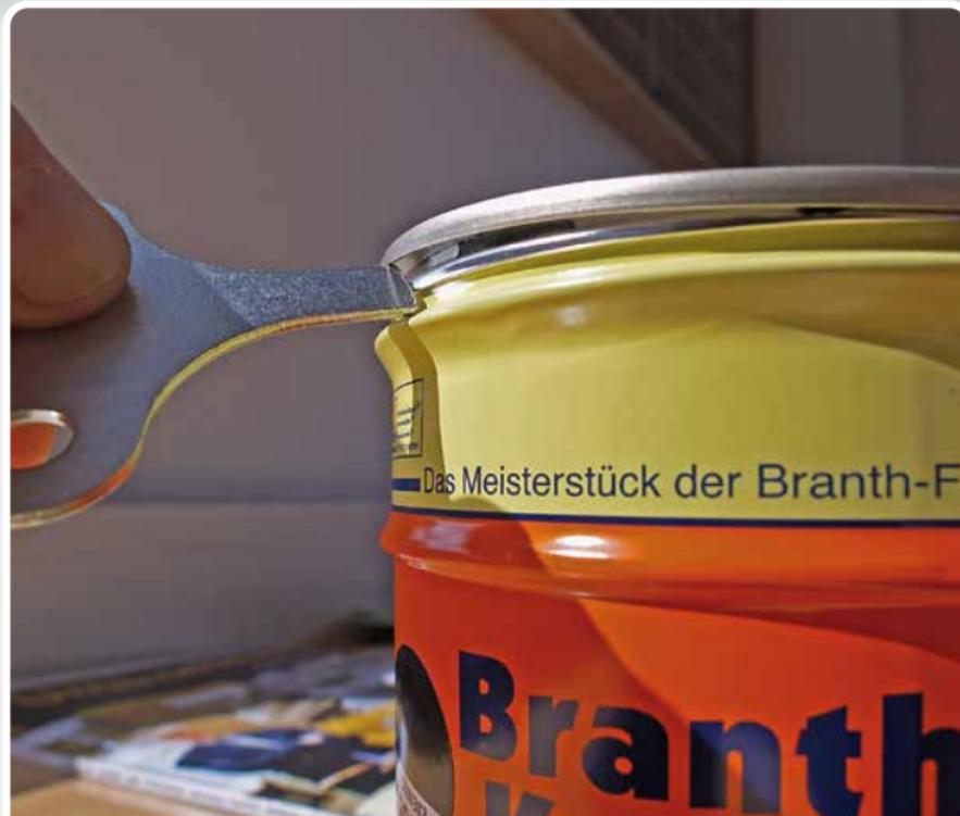
Zum Öffnen der **750-ml-Dose** einen **großen** Schraubendreher verwenden, und unter der Deckelkante drehen, nicht hebeln. Oder verwenden Sie unseren praktischen Schlüssel.
