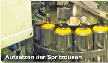
Aufsetzen der Spritzdüsen
